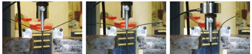
CFK-Probe kurz vor Probenbruch
